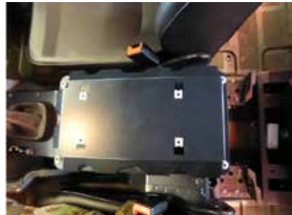
Abbildung 25: Hauptsicherungskasten 2te Abdeckung
